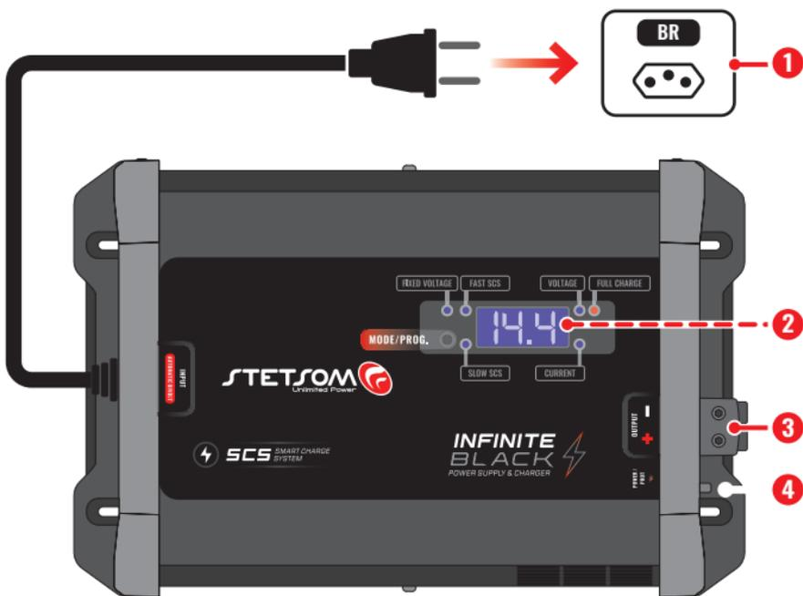
**1. CONECTOR DE ALIMENTACIÓN DE CA:** Conéctelo a una toma de corriente compatible para el funcionamiento del producto. No use adaptadores ni doble el cable, esto puede reducir la eficiencia o hacer que el cable funcione mal.
